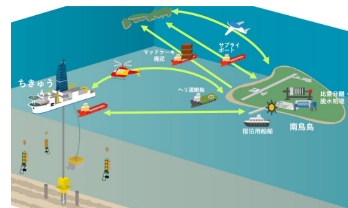
令和9年レアース泥採鉱試験概念図
