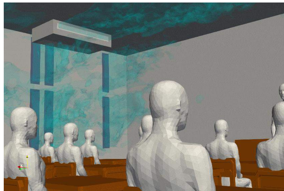
窓開け換気の様子
