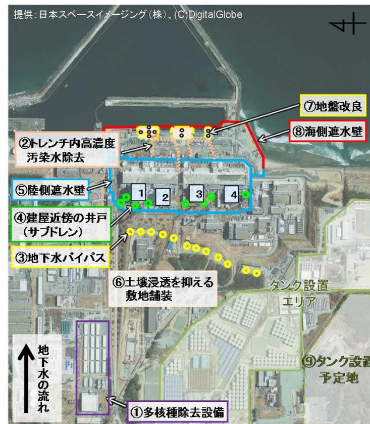
建屋への地下水流入を抑制、建屋内滞留水を減少させるため地下水の水位を制御
