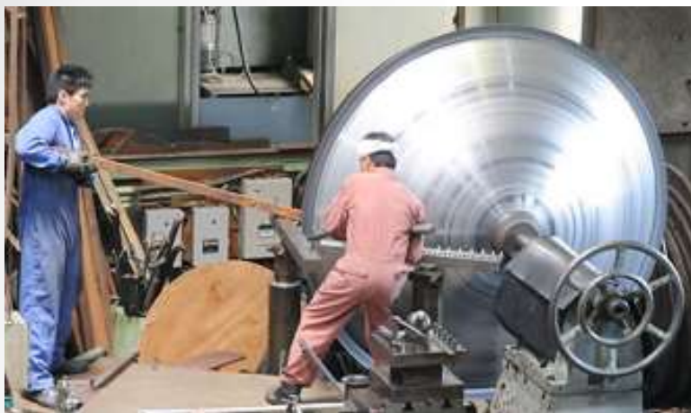
(株)北嶋絞製作所 (人工衛星機器部品・航空機部品) “特殊金属のへら絞り加工 パラボラアンテナからH-IIロケットまで”
